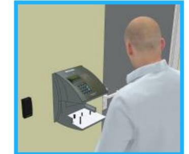
Systém EISS integruje biometrické snímače, umožňují řízení přístupu na základě biometrických charakteristik osob a zajistuje správu a distribuci biometrických vzorků do snímačů. Vjezd a tyto jeho součásti jsou řízeny systémem EISS.
