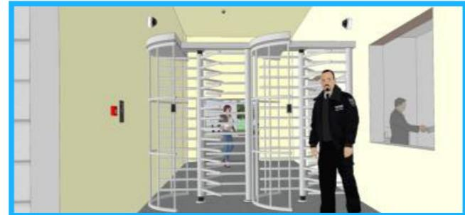
Vstupní vrátnice může být řízena a spravována systémem EISS. Vrátnice může obsahovat turnikety řízené přístupovým systémem s možností biometrické identifikace, docházkové terminály, interkom, evidenci návštěv a další zařízení, které obsluhuje EISS. EISS nabízí i špičkové řešení pro vysoké zabezpečení vstupu.
